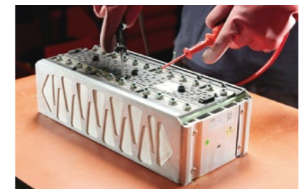
Das Separieren und Ersetzen von Batteriemodulen, ist Hochvoltexperten der Stufe 3S vorbehalten und steht heute noch am Anfang.
