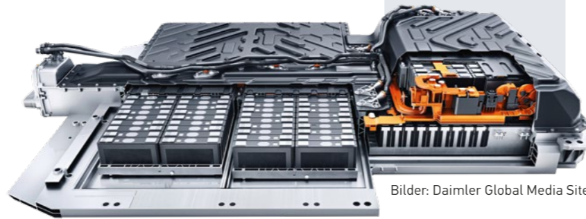
Im Mercedes EQA 250 mit 140 kW sitzt eine doppelstöckige Lithium-Ionen-Batterie als strukturelles Element im Unterboden des Fahrzeugs. Sie hat eine Maximalspannung von 420 V und einen nutzbaren Energieinhalt von 66,5 kWh.
